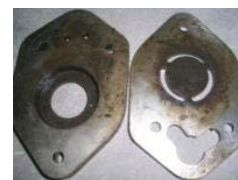
Verkohlte Ventile und Ventilteller
