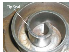
Geschmolzenes Tip Seal; Scroll-Spirale mit Riefen
