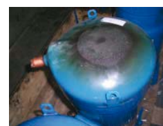
Verkohltes oder verfärbtes oberes Gehäuse
