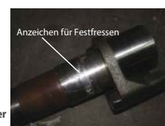
Lager festgefressen, weil der Ölfilm durch Wasser zerstört wurde
