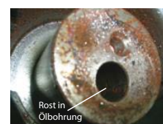
Innenfläche der Ölöffnung ist mit Rost überzogen
