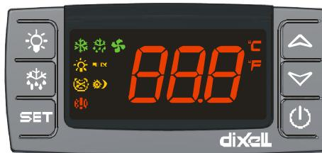
**SET**: Pour afficher le point de consigne. Dans le mode programmation, permet de sélectionner un paramètre ou de confirmer une opération.
